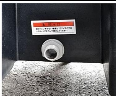
キャップを外しタンク内の残留水を排水します。
