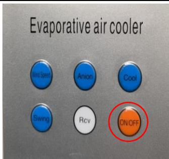
乾燥後、(ON/OFF) ボタンを押して運転を停止させます。
